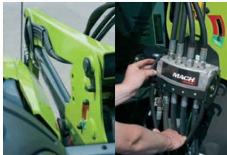
Благодаря специальному индикатору оператор может проверить надежность закрепления устройства на фронтальном погрузчике из кабины.
