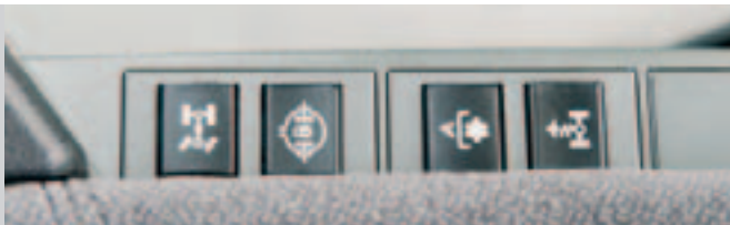
Панель управления (11) в подлокотнике: полный привод, блокировка дифференциала, автоматика вала отбора мощности и подвеска переднего моста
