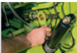
Механическая настройка противорежущей пластины
