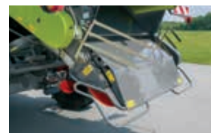
Валкоукладчик на ACTIVE SPREADER
