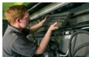
Смена предварительных дек MULTICROP
