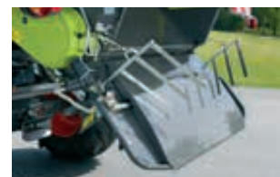
Валкоукладчик на дефлекторе распределения соломы
