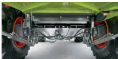
Цилиндры жатки двойного действия точно регулируют давление на почву.
