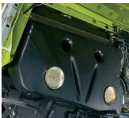
Топливный бак объемом до 650 л.
