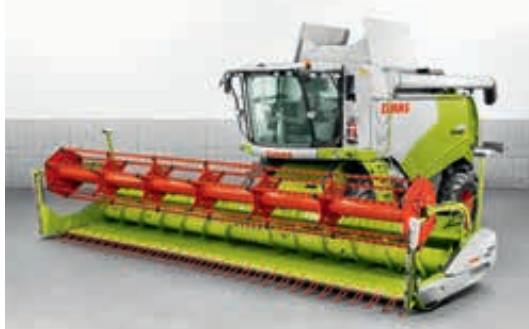
Жатка VARIO с оборудованием для уборки рапса
