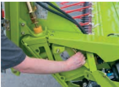
Блокировка стеблеотделителей и рапсовых ножей без инструмента
