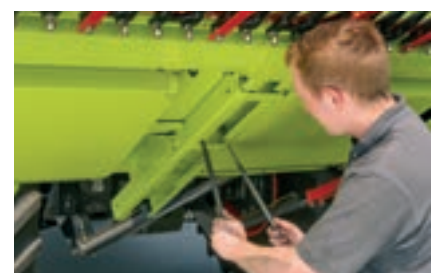
Регулировка длины стола на CERIO 930 и 770
