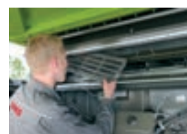
Быстрая смена сегментов благодаря подбарабанью MULTICROP
