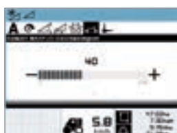
Скорость ленточных транспортеров плавно регулируется в CEbis.
