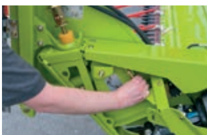
Блокировка стебледелителей и рапсовых ножей без инструмента
