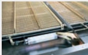
Электрическая настройка решета
