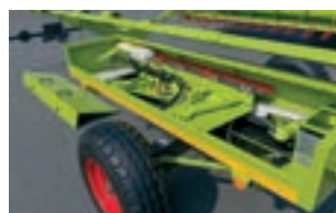
Съемное отделение для оборудования для уборки рапса
