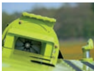
Для свободного обзора: отсос пыли на наклонной камере
