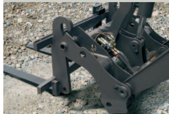
Гидрозамок на стреле погрузчика значительно расширяет сферу применения машины
