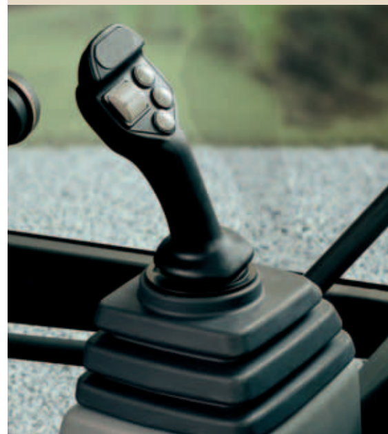
Запатентованный многофункциональный рычаг-джойстик для эффективной работы
