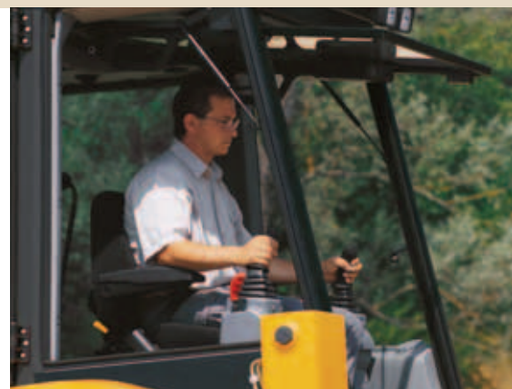
Джойстики с сервоприводом: точность, плавность и простота управления машиной
