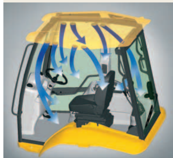
Воздух распределяется по кабине с помощью оптимально расположенных дефлекторов
