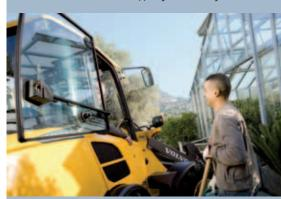
Полностью открываемое боковое окно обеспечивает хорошую вентиляцию.
