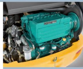
Высокопроизводительный 4-цилиндровый дизельный двигатель Volvo.
