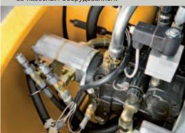
Отдельные гидравлические насосы для рабочего оборудования и рулевого управления.
