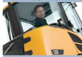
Закругленный капот двигателя обеспечивает хорошую обзорность назад.
