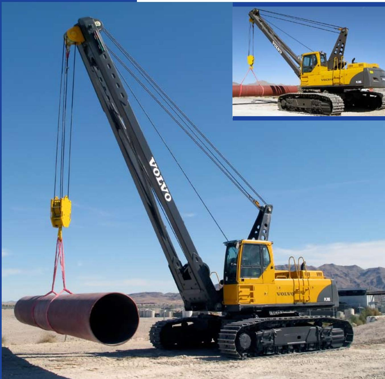
Трубоукладчики Volvo разработаны и изготовлены в расчете на тяжелые условия эксплуатации, характерные для трубопроводного строительства. Они сочетают в себе передовые решения в части безопасности с современной технологией подъема и укладки грузов при повороте на любой угол. Машина может быть переоборудована в обычный экскаватор, что расширяет возможности ее использования.
